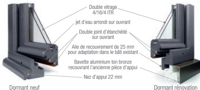
Le profil RENOVATION est conçu pour une adaptation dans le bâti existant (lorsque l'état de ce dernier le permet). Une bavette aluminium laquée blanche ou bronze dissimule l'ancienne pièce d'appui tout en assurant sa conservation par une bonne ventilation. Son profil élancé permet de limiter la réduction du clair de verre.
